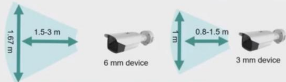
Área de cobertura de la cámara termográfica.
